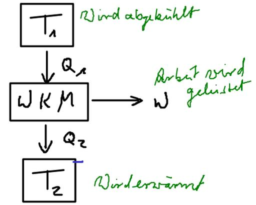
Maschine bleibt stehen wenn  $T_1 - T_2$  erreicht ist.
