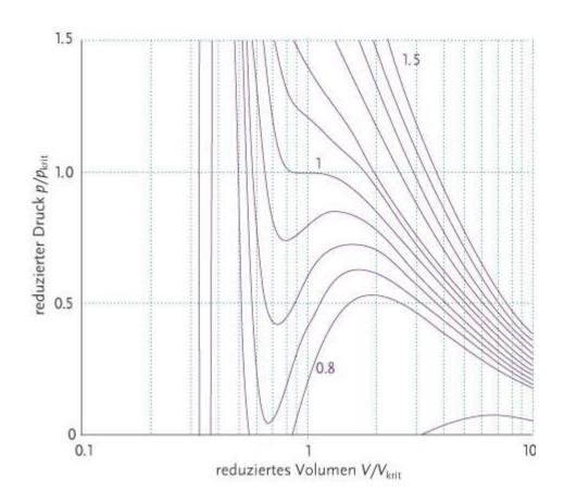
Van-der-Waals-Isothermen für verschiedene Werte von  $T/T_{krit}$ ; Die van-der-Waals-Schleifen werden in der Regel durch horizontale Linien ersetzt. Für die kritische Isotherme gilt  $T/T_{krit} = 1$ .
