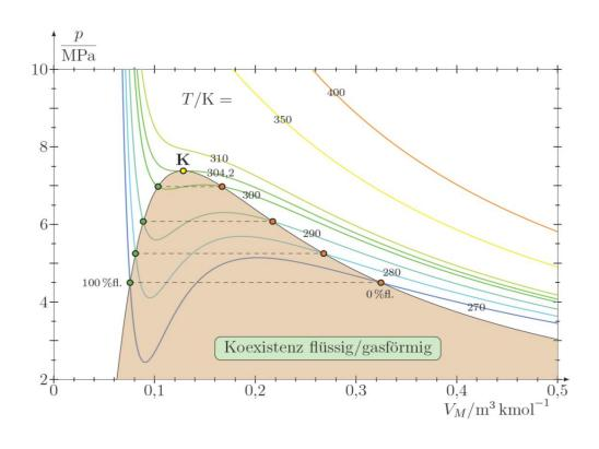
pV-Diagramm für VdW-Gas mit Zweiphasengebiet:
